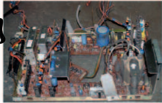
Leiterplatte mit Elektrolytkondensator (blauer Zylinder) Foto (c): VISP GmbH
